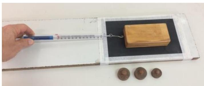
Quando o corpo de prova ficar na iminência do movimento, a força aplicada pelo dinamômetro será igual à força de atrito estático máximo.
