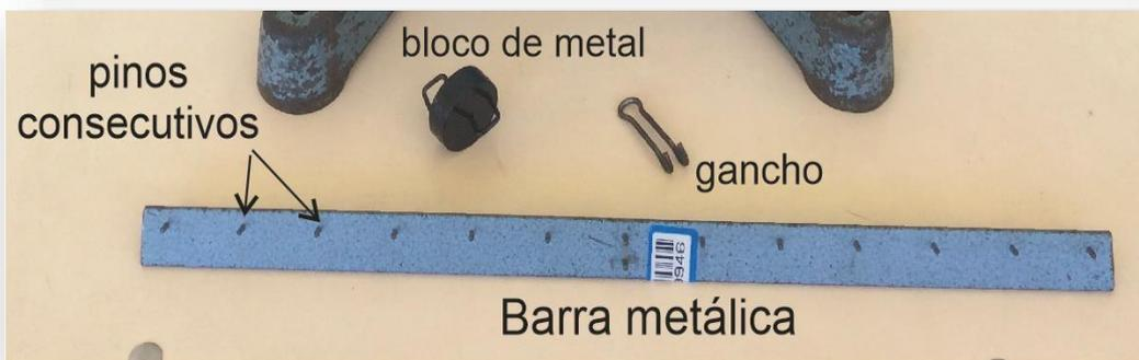
2. Utilize o dinamômetro e meça o peso da barra metálica e do bloco de metal. Com a régua meça a distância entre 2 pinos consecutivos da barra.
