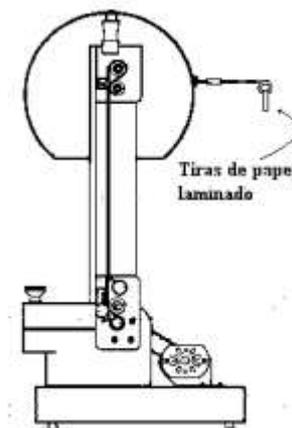
**04-** Cole tiras de papel laminado interna e externamente em uma gaiola metálica colocada sobre um suporte isolante. Ligue a superfície da gaiola à cúpula do gerador por meio de um cabo condutor. Ligue o gerador.
